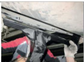
**ШАГ 2.** Закрепите центральный кронштейн, совместив его отверстия с отверстиями в лонжеронах автомобиля. Прикрутите кронштейн к штатным закладным гайкам в лонжеронах автомобиля с помощью болтов M12x40, через шайбы 12 гроверные и шайбы 12.
